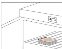
5. 将测试片正面向上，放置于恒温培养箱中， 36^{\circ}\text{C} \pm 1^{\circ}\text{C} 培养 18~24h，测试片堆叠不得超过 20 张。
